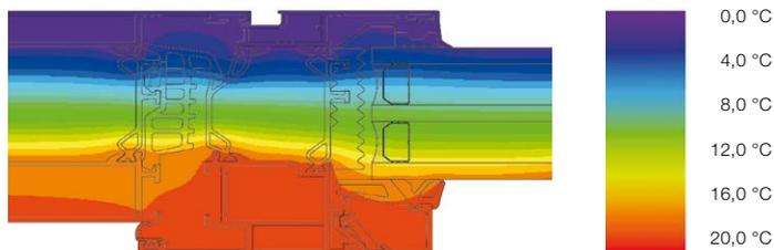
Isothermenverlauf nach Uf EN ISO 10077-2. Durch die zentrale Lage des Glases verlaufen sowohl die Temperatur in der Konstruktion als auch das Gewicht nahezu parallel und mittig zu Fensterebene.
